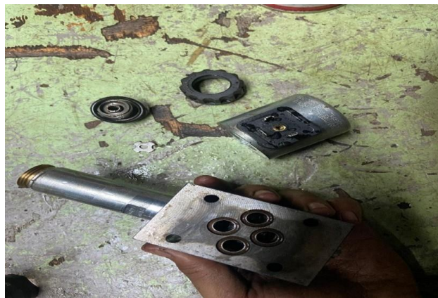
Gambar 10. Pembongkaran Solenoid Valve Sumber: Dokumentasi Pribadi (2024)
