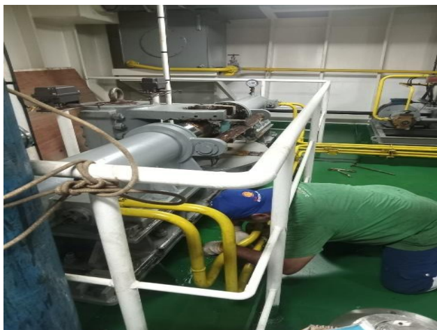
Gambar 1. Pengecekan Selenoid aktuator Steering Gear
