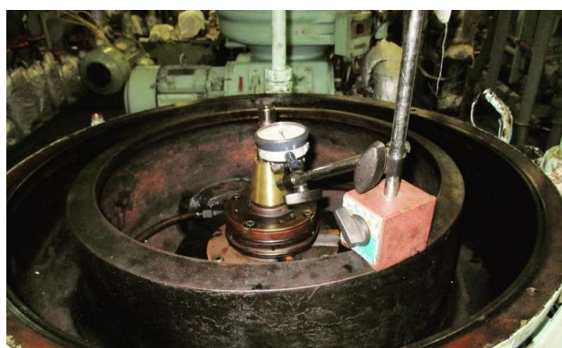
Gambar 3. Pengukuran Dial Shaft Purifier Sumber : Dokumentasi Pribadi
