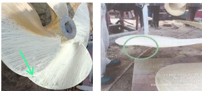
Gambar 3. Ujung daun propeller kanan yang rumpil dan bengkok
