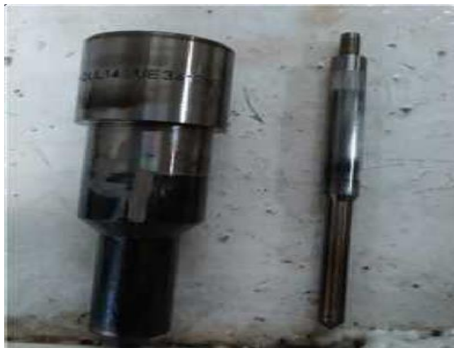
Gambar 4. Kondisi nozzle dan jarum pengabut yang kotor Sumber: Dokumentasi penelitian di TB Nisrina Riski Samudera VI
