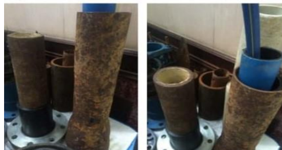
Gambar 2. pipa yang terdampak kerak lumpur
