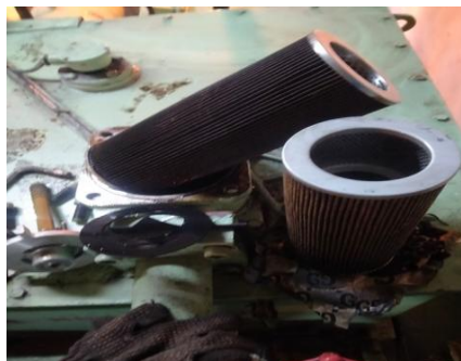
Gambar 6. Pembersihan Hydraulic Filter Sumber : Dokumentasi Penulis
