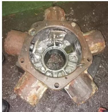
Gambar 4. Kerusakan Windlass Hydraulic Motor Sumber : Dokumentasi Penulis
