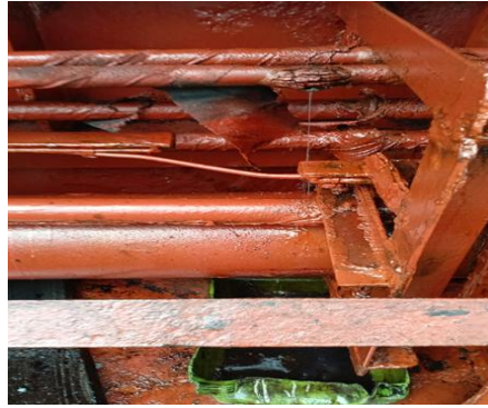
Gambar 5. Kebocoran Hydraulic Pipe Sumber : Dokumentasi Penulis
