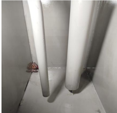
Gambar 7. Pembersihan Hydraulic Tank Sumber : Dokumentasi Penulis
