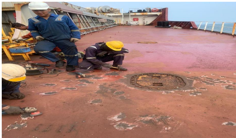
Gambar 3. Proses Chipping dan Brushing Sumber: Dokumen Pribadi
