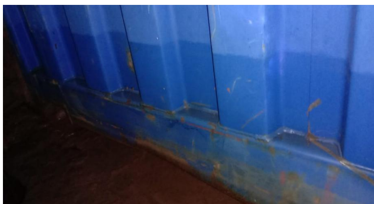
Gambar 3. Kondisi palka yang terendam air Sumber : Dokumen Pribadi
